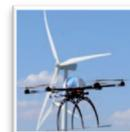
Una de sus principales productos es el EOL6, un helicóptero plegable destinado a la inspección de palas de aerogeneradores. El empleo del Aracnocóptero Eol6 posibilita rapidez en las inspecciones, con tiempos de parada mínimos y una gran reducción de recursos y logística en las mismas.
