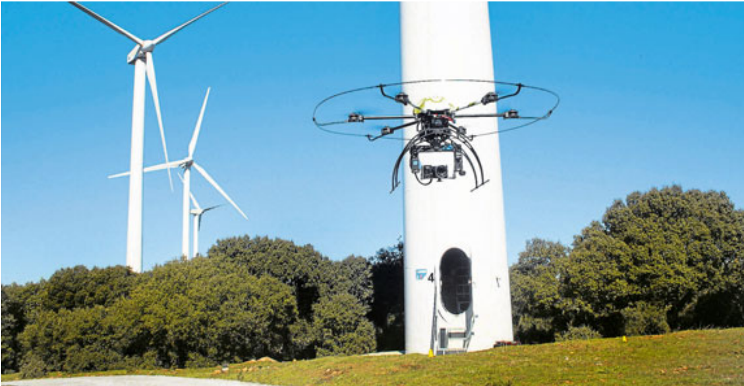
El innovador robot ha sido diseñado y ejecutado por una empresa salmantina y permitirá ahorrar costes en la revisión de aerogeneradores. | FOTOS: EÑE
