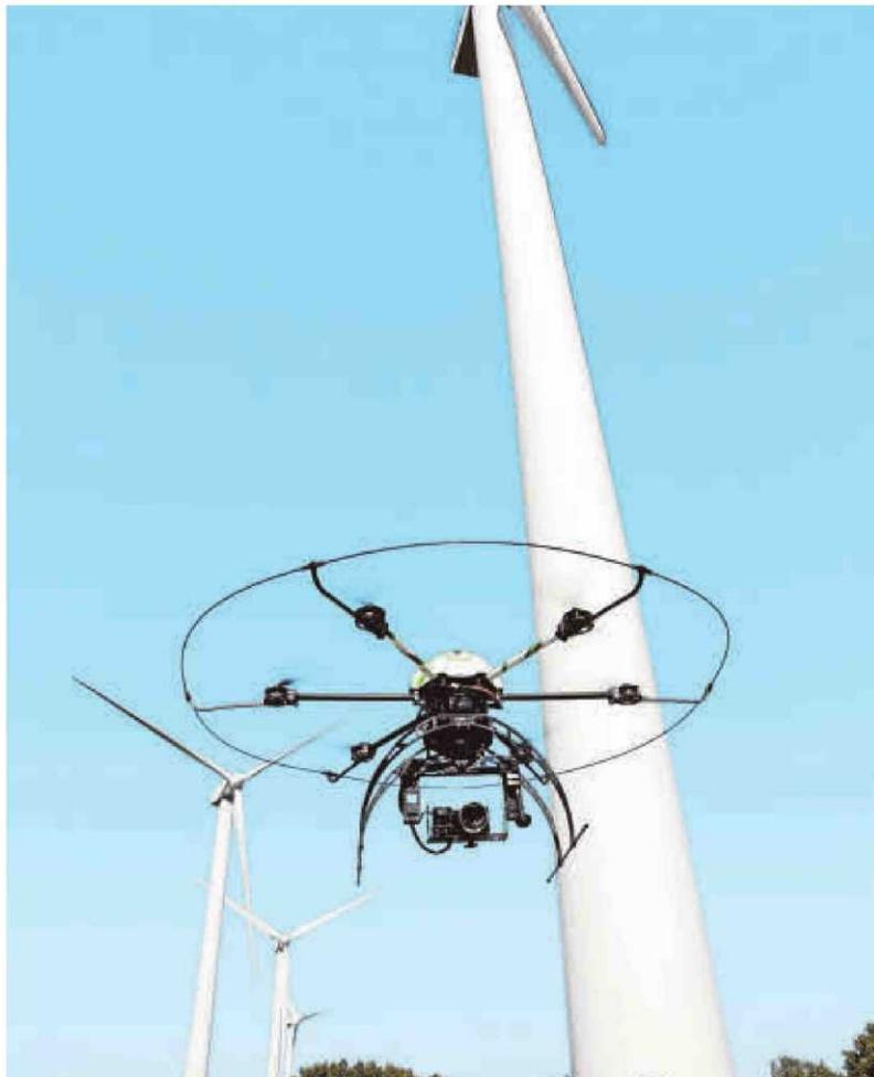
**CONTROL.** El "aracnoptero" de la empresa Arbórea comprueba el estado de los aerogeneradores de Iberdrola.
