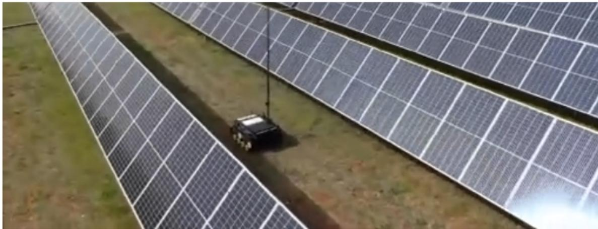
**24/7.** Con un peso de 285 kilos, el robot tiene una autonomía de 30 horas gracias a sus baterías y el motor, evidentemente, también es eléctrico. Esto hace que sea silencioso y no emita ni humo ni residuos. Además, la empresa asegura que puede operar también de noche y es algo que nos recuerda muchísimo a esos cortacésped robot que son ideales para el jardín (aunque sin el avanzadísimo sistema de sensores).
